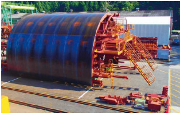
写真4 トンネル内のコンクリート打設に用いられるセトル
