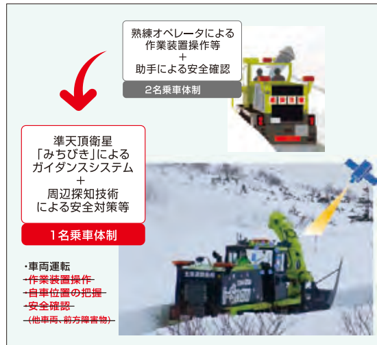
図7 i-Snowにおけるロータリー除雪車の省人化
