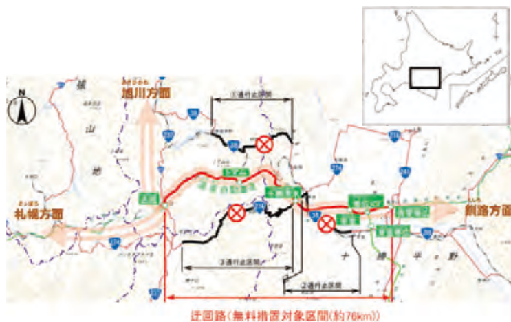
図6 高速道路と国道のダブルネットワークの効果の発揮 (2016年8月台風における事例)
