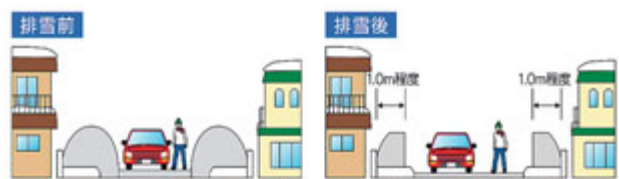
図-7 除雪パートナーシップ制度による排雪断面のイメージ
