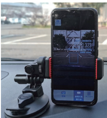
図7 路面すべり推定アプリケーション (上:車載端末による路面すべり摩擦係数の推定実施例、 下:路面すべり摩擦係数の推定結果表示例)
