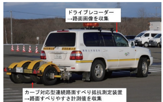
図4 路面すべり摩擦係数計測値、および路面画像の収集用車両
