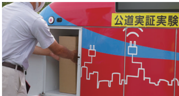
写真3 車体の両側面にロッカーを20個搭載している
