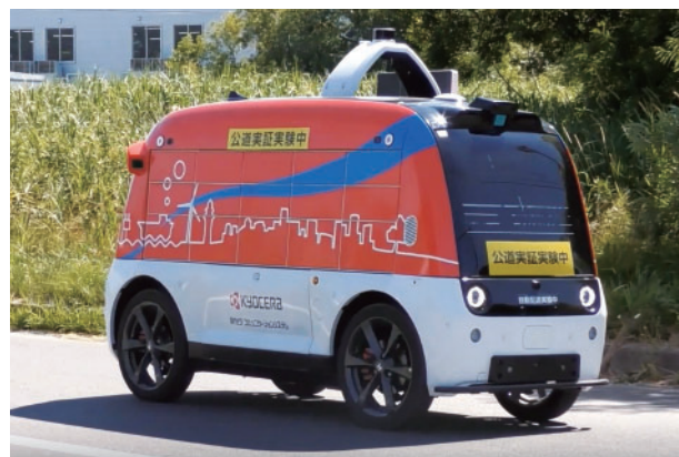
写真2 石狩湾新港地域を走る自動走行ロボット。従来よりも大型・高速の車体で車道を走行する、国内初の実証となった
