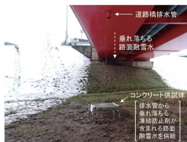
写真2 暴露実験の様子(北海道内20箇所で実施)
