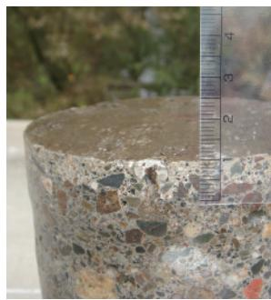
写真5 吸水防止層(コア側面に水を噴霧)
