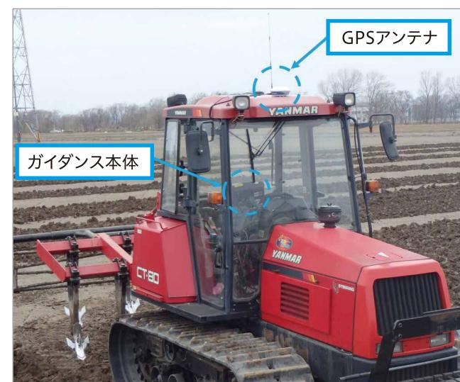
写真1 農業トラクターGPSオートステア
