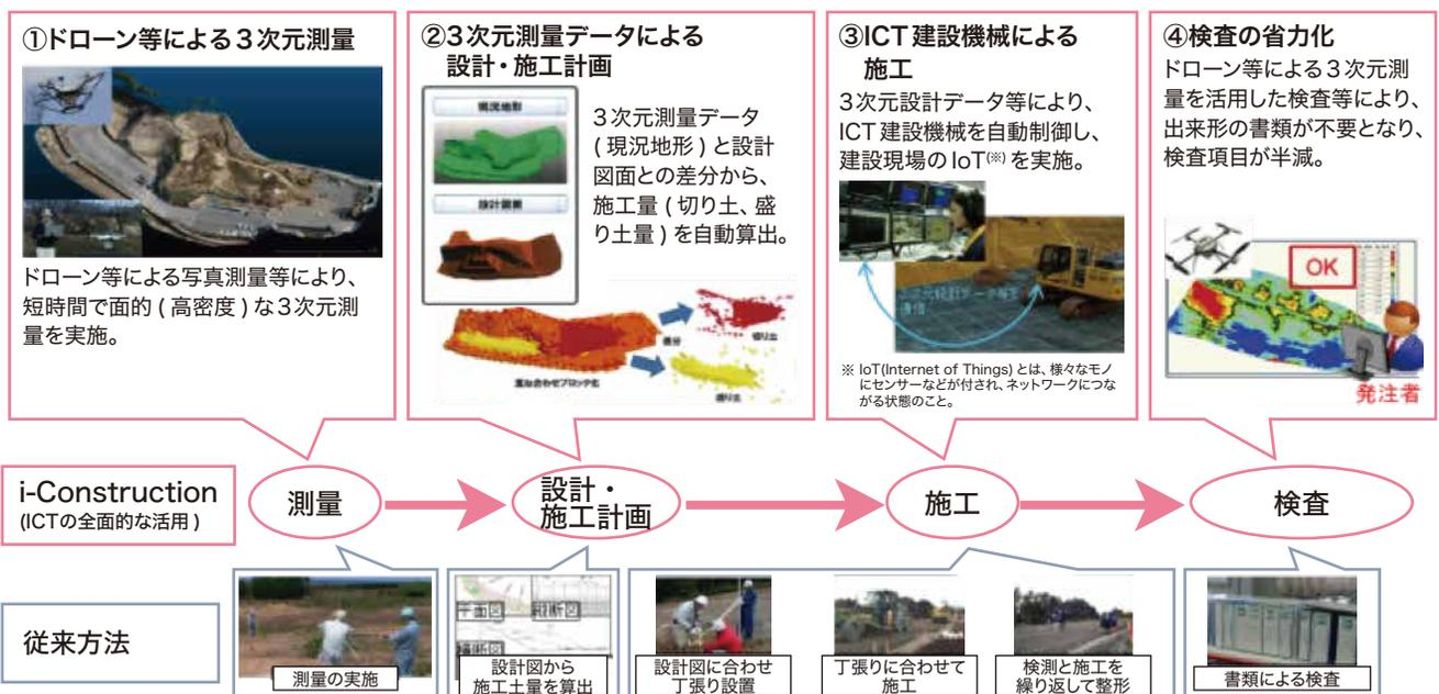
図4 従来工法とICT施工の流れ
