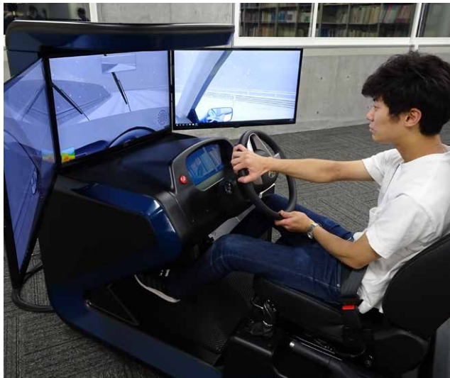
写真3 ドライビングシュミレーターを活用した冬期路面における自動運転システムの安全評価
