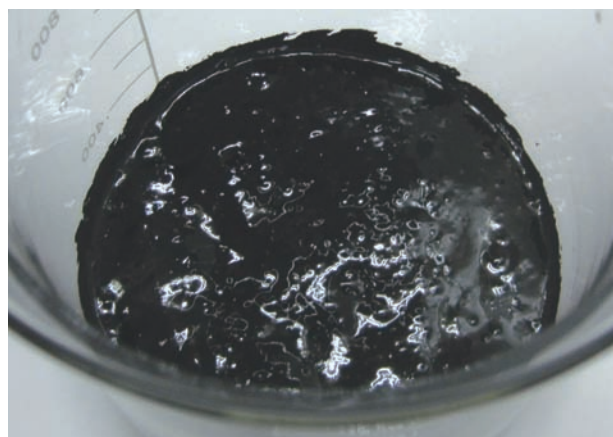
▲写真1 発泡系の中温化剤をアスファルトと混合した状況
