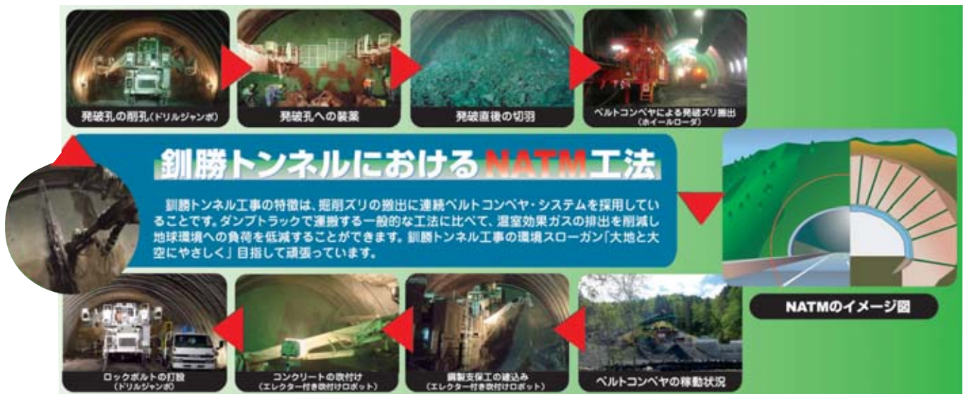
釧勝トンネルにおけるNATM工法
