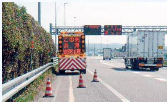
「この先渋滞追突注意」と標示し、渋滞末尾への注意を喚起
