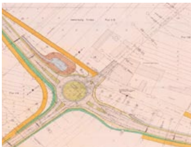
図-4 国道258号と州道113号が交差する小型ラウンドアバウトの設計平面図
