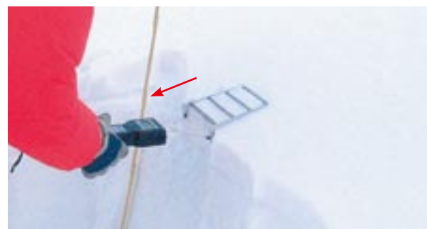
写真1 シアーフレームを使った試験
