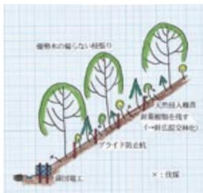
図-4 切り土法面に天然侵入して成立した樹林の倒伏防止対策(図-3からの基礎工設置および保育手法; 模式図)
