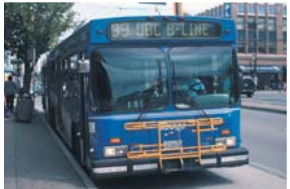
写真-7 低床式のバス フロント部にある黄色の金具は自転車のキャリア
