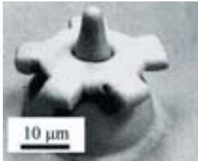
フェムト秒レーザーを光硬化性樹脂に集中照射して作製したマイクロギアホイール
