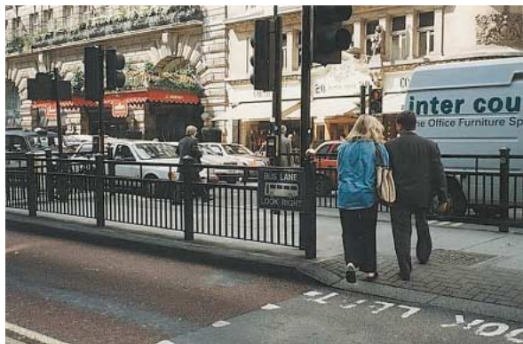
写真5 ロンドン中心地区における信号付きクランク方式の横断歩道—一般的に信号の間隔が短いため、一回でこれらの歩道を横断することは大変である
