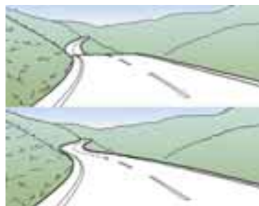
図 - 1 ストレスを与える線形と与えない線形
