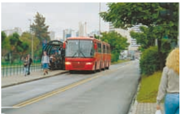
写真-14 ユニークなバスシステム-三連バスとバス停、バスレーン
