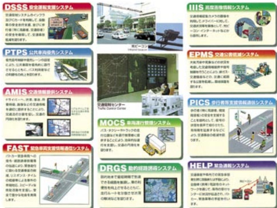
図-1 警察が推進するUTMSの各サブシステム
