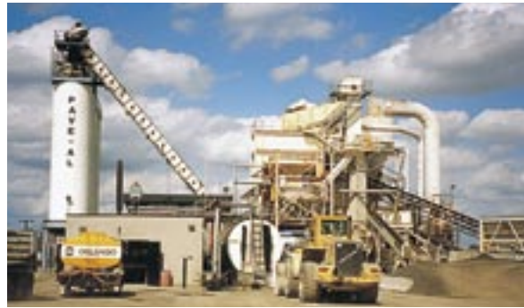
製造能力 400t/hr というアスファルトプラント
