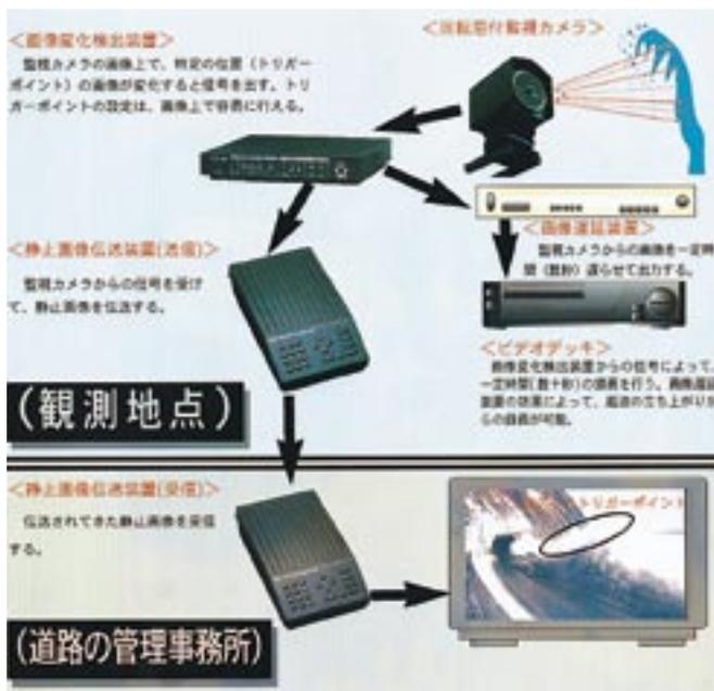
図-1 越波監視システム構成図
