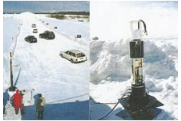
(写真-2) インテリジェント・デリニエータ・システムの実験状況とミリ波レーダ
