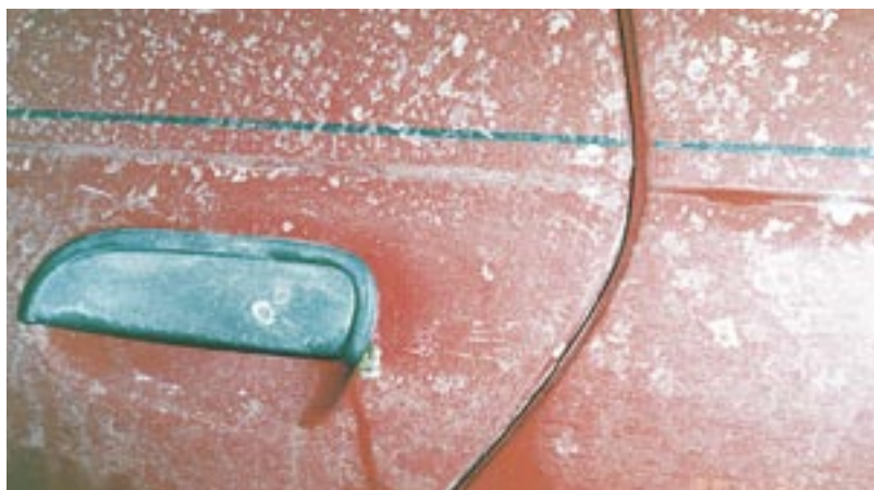
(写真-1) 塩で白く汚れた車体の一部
