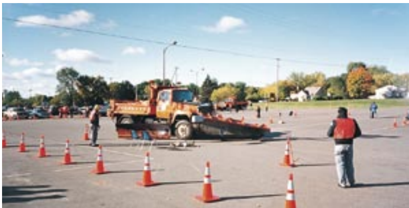
(写真-2) サイドブラウによる郵便受け周りの除雪に関する実技試験
