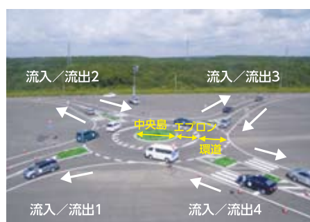
写真-2 実車走行実験(秋期:乾燥路面)
