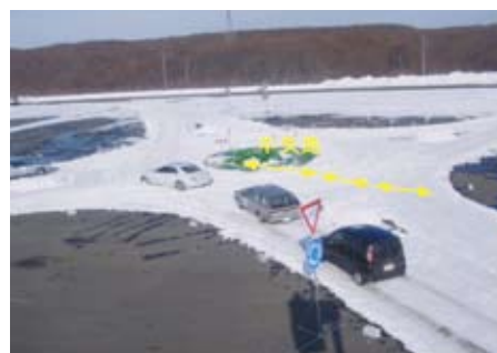
写真-3 実車走行実験(冬期:雪氷路面(圧雪))
