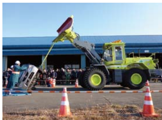
除雪ドーザによる車両の移動
